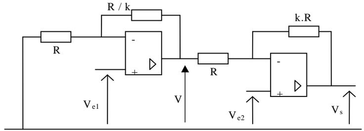
Les deux A.O. sont en rétroaction et sont supposés idéaux :  $i_+ = i_- = 0$  et  $V_+ = V_-$ .
