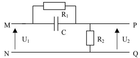
a) Calculer le transfert complexe  $\underline{H}(j\omega)$  du circuit et déterminer en fonction de  $R_1$  et  $R_2$  le coefficient  $A$  tel que  $\underline{H}(j\omega) = \underline{U}_2 / \underline{U}_1 = (1 + j.v) / (A + j.v)$  où  $v = R_1.C.\omega$ .
