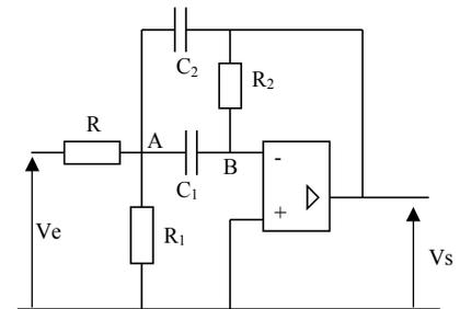
on obtient :  $\omega_0 = \frac{1}{\sqrt{R R_2 C_1 C_2}} \sqrt{\frac{R + R_1}{R_1}}$  et pour facteur de qualité :  $Q = \sqrt{\frac{R_2 C_2}{R C_1}} \sqrt{\frac{R + R_1}{R_1}} \frac{C_1}{C_1 + C_2}$
