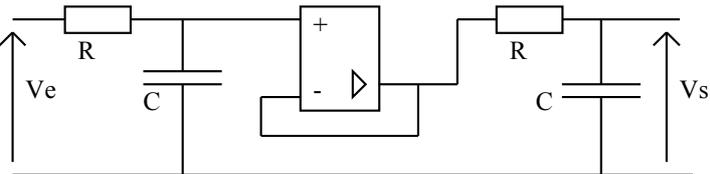
3°) Déterminer la fonction de transfert  $H(j\omega) = U_s/U_e$  pour le montage (B) en fonction de  $\omega$ ,  $\tau = RC$  et le coefficient sans dimension  $a$ . ( $a$  est une constante positive). Discuter l'influence de  $a$  sur cette fonction de transfert  $H(j\omega)$ . Calculer la quantité  $[H_1(j\omega)]^2$ . Conclusions ?
