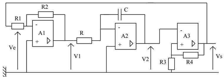
1°) A l'instant  $t = 0$ , la tension de sortie  $V_s$  est égale à  $V_s = +V_{\text{sat}}$ . Le condensateur de capacité  $C$  n'est pas chargé. Etudier l'évolution de  $V_2(t)$  jusqu'au basculement de  $V_s(t)$ .
