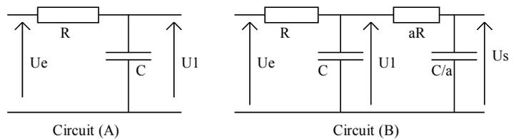
1°) Déterminer l'expression du transfert  $H_1(j\omega) = U_1/U_e$  pour le circuit (A), en
