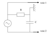
b) On mesure T = 1,0 ms donc f = 1,0 kHz ;  $\phi_C = 2\pi.\Delta t/T \text{ avec } \Delta t = -0.25 \text{ ms (} u_C \text{ est en retard sur } u_R) \text{ et } T = 1.0 \text{ ms d'où } \phi_C = -\pi/2 \text{ ;}$
