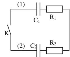
$$R : a) \quad i = \frac{dq_1}{dt} = -\frac{dq_2}{dt} \quad \text{d'où } q_1 + q_2 = \text{cste} = q_0. \quad \text{puis écrire la loi de maille et en tirer une équation}$$
