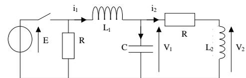
b) Au bout d'une durée  $t_0$  suffisante pour que le circuit ait atteint un régime permanent, l'interrupteur est ouvert. Déterminer les valeurs à  $t_0$  de  $V_1$  et  $V_2$  ainsi que des intensités  $i_1$  et  $i_2$ . En déduire les valeurs des dérivées temporelles de  $V_1$  et  $V_2$  à l'instant  $t_0$ .
