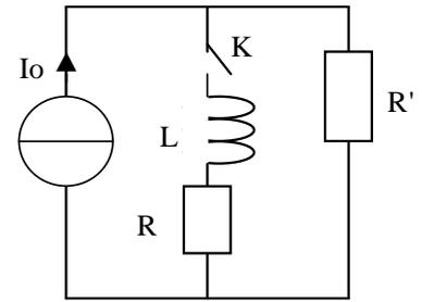
$$R : \text{équation du circuit} : \frac{di}{dt} + \frac{R + R'}{L} i = \frac{R'}{L} I_0$$
