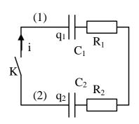
b) W sera la différence entre l'énergie électrique initialement contenue dans le condensateur  $C_1$  et l'énergie électrique résiduelle à l'état final dans les deux condensateurs.
