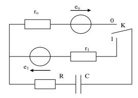
La condition de continuité sur q(t) impose :  $q(t_1) = Ce_0/2 = q(t_1) = -Ce_1 + A.exp(-t_1/\tau_1)$ D'où  $A = C(e_0/2 + e_1)$ .  $exp(+t/\tau_1)$ .
