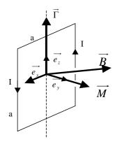
Une bobine correspond à une accumulation de spires de même section S, parcourues par un courant d'intensité I. Elle permet, par additivité des champs magnétiques produits par chaque spire, d'obtenir des champs plus intenses.
