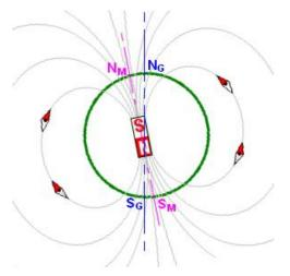
Le champ magnétostatique  $\vec{B}$ , est une grandeur vectorielle qui détermine en chaque point de l'espace la direction et l'intensité des actions magnétiques exercées par une distribution d'aimants ou de courants permanents.
