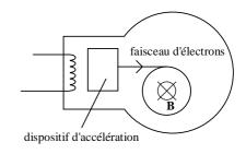
Le rayon de l'hélice ou de la trajectoire circulaire est proportionnel à la vitesse d'entrée des électrons (du moins de sa composante orthogonale au champ) et inversement proportionnelle à la norme du champ magnétique, B.
